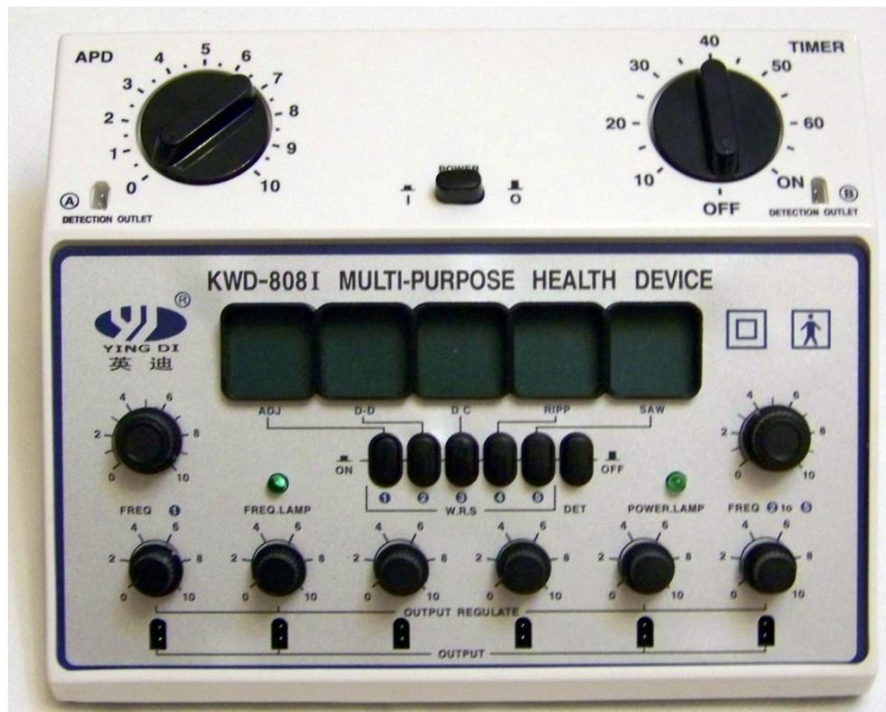
Questo stimolatore, come il precedente, appartiene alla generazione "analogica", quindi privo di display e con regolazioni a potenziometro, anche questo dispone di doppia alimentazione (batterie/corrente di rete) e una protezione che impedisce l'erogazione in uscita se si è accidentalmente dimenticato un potenziometro aperto.
